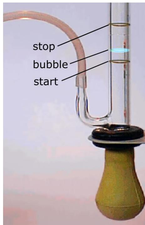
Fig. 38: Bubble flow meter
